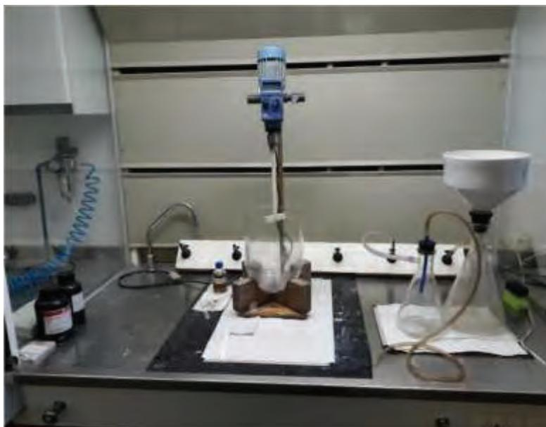
Figura 6. Alvejamento químico com ditionito de sódio.
