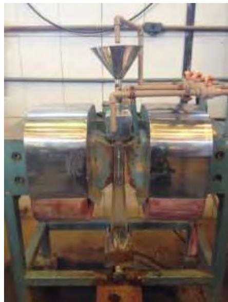
**Figura 5. Separador magnético Boxmag Rapid (14.000 Gauss).**
