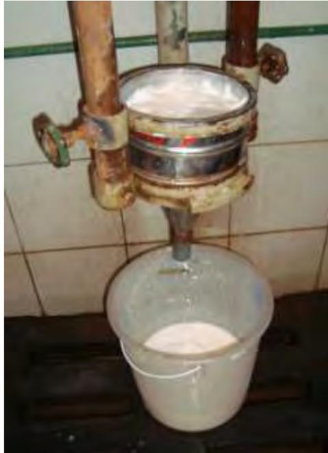
**Figura 4. Classificação granulométrica a úmido.**
