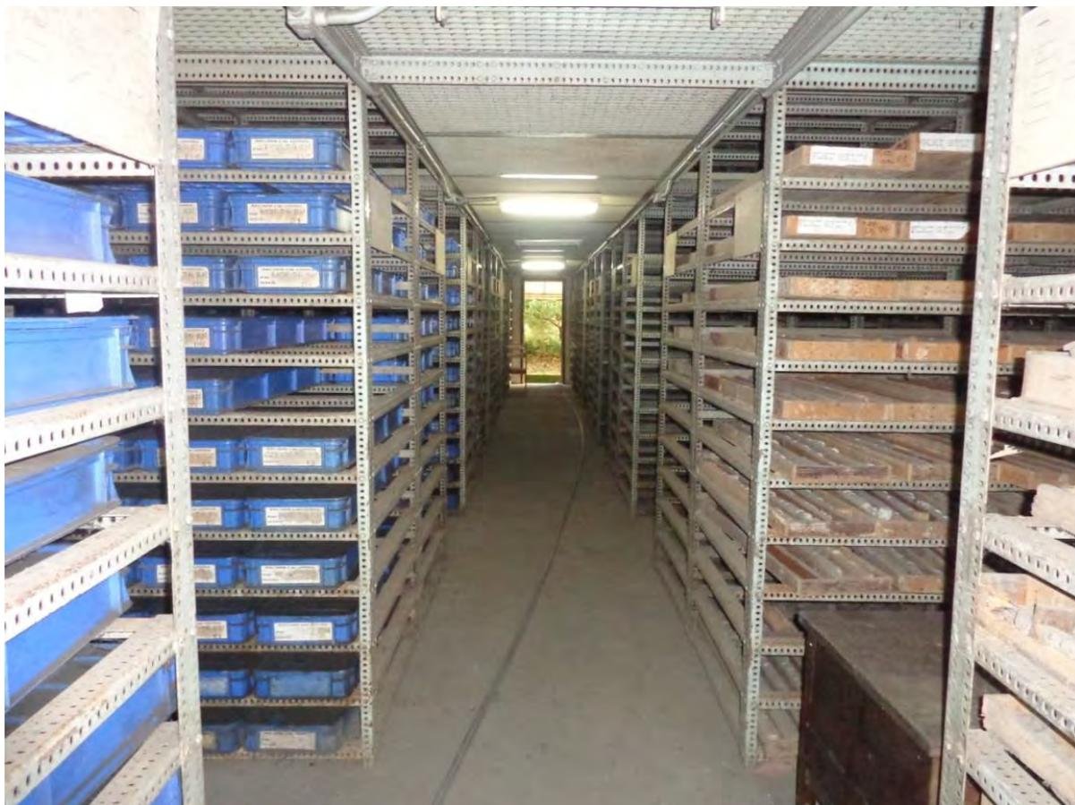
**Figura 82** – Caixas de acondicionamento dos testemunhos de sondagem.
