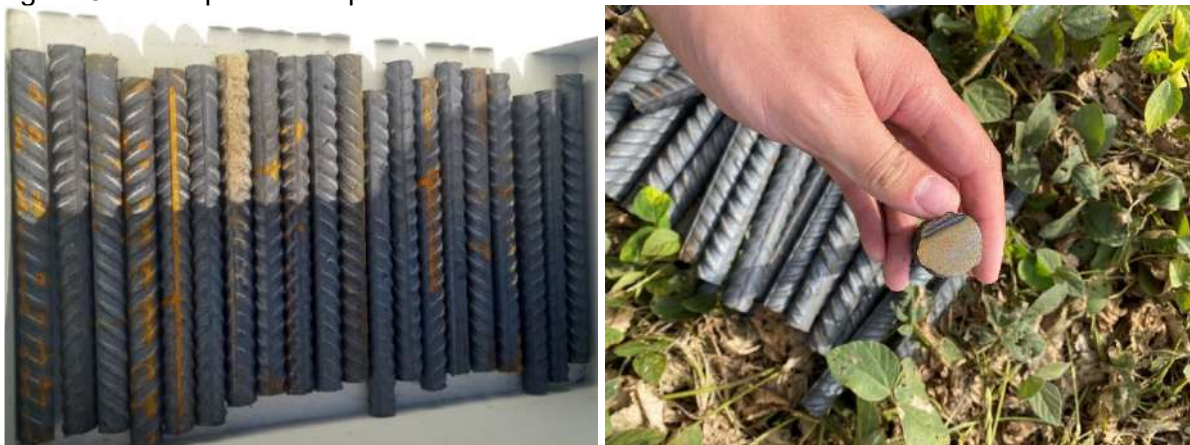
Figura 8 - Exemplares dos pinos de erosão instalados na Área III - Rio Pio.
