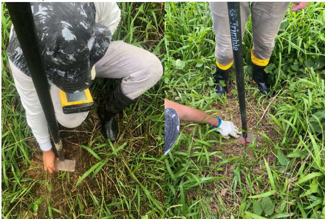
Figura 9 - Leitura das coordenadas e sua altitude em relação ao Datum Vertical: Marégrafo de Imbituba – SC, com RTK.
