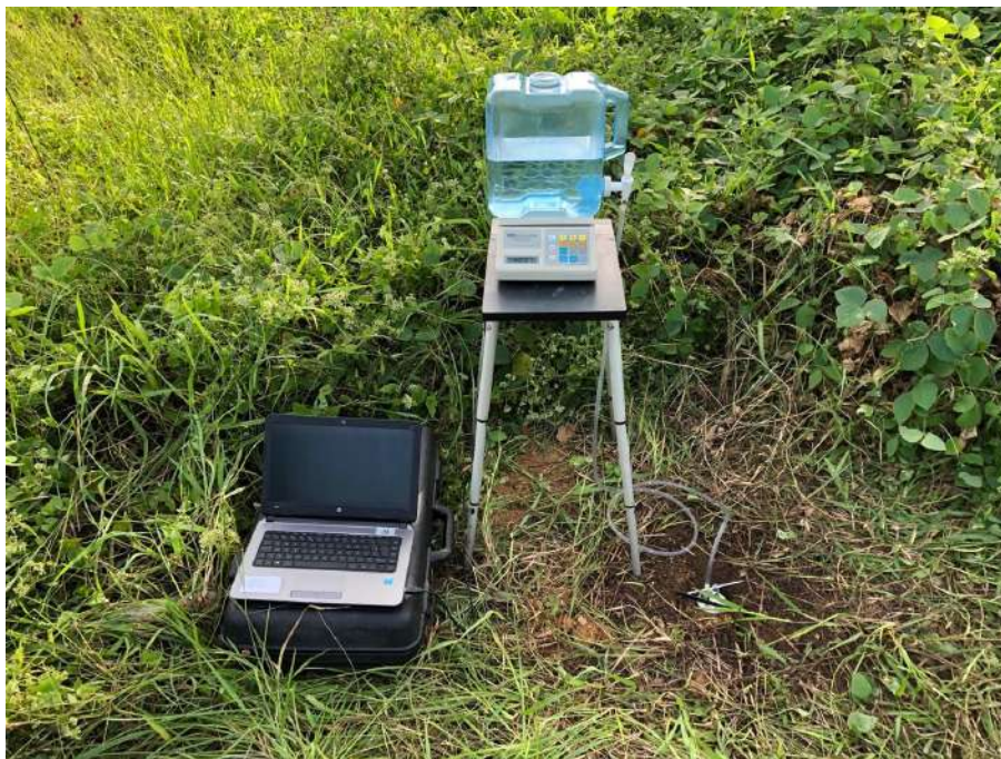
Figura 5 - Ensaio de permeabilidade, com carga constante, realizado com Permeômetro Aardvark.
