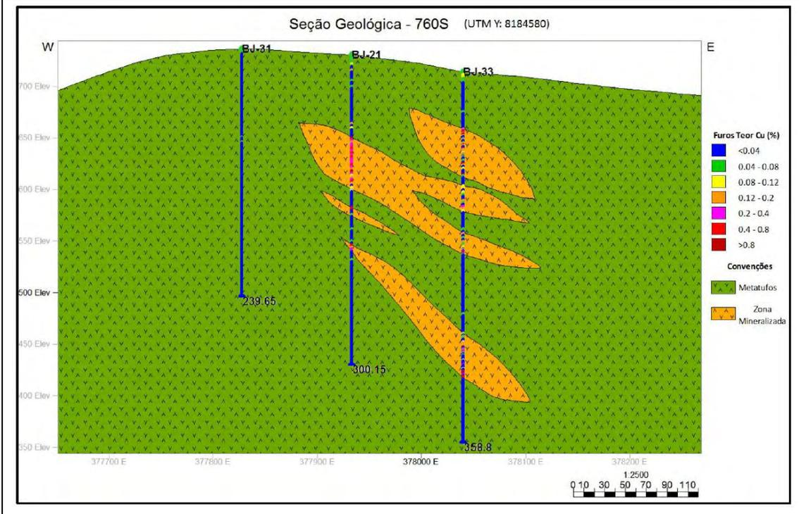
O modelo foi preliminarmente construído e estimado considerando halos anômalos de Cu > 0,04%. A partir desse modelo de blocos, criaram-se *wireframes* somente em volta dos blocos com teor maior que 0,2% de cobre. Ressalta-se que o envoltório de Cu > 0,04% não constava no modelo de blocos final utilizado pela CPRM.
