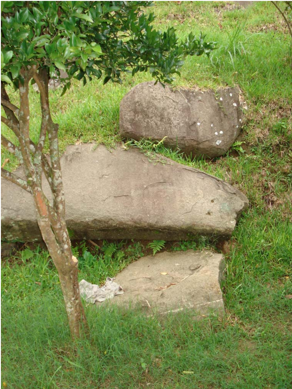
Foto 05 – Blocos de rocha soltos na encosta a montante de residências no Jardim Ouro Preto.
