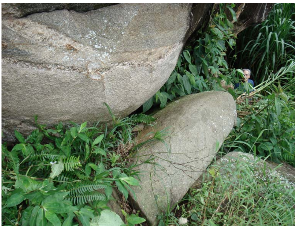
Foto 09 – Base do bloco rochoso. Observar “encavalamento” de pedra menor sobre outra adjacente, aparentemente empurrada pelo bloco maior.
