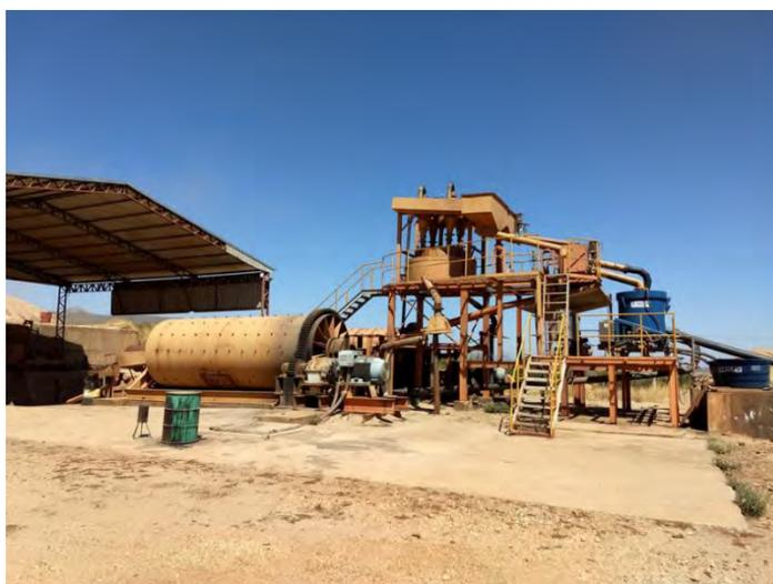
Figura 3 – Instalações para britagem e classificação de minério da concessão garimpeira Terra Vermelha (Foto: Angeval Alves de Brito).
