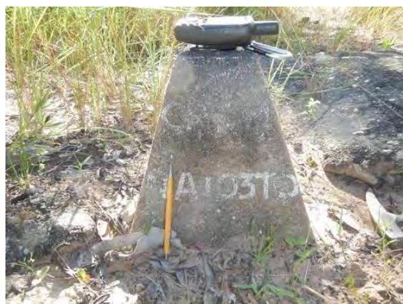
Para identificação do geoposicionamento dos furos de sonda foi empregado equipamento de GPS geodésico diferencial GeoTech, que possui duas antenas receptoras, uma fixa num local previamente determinado (denominada base), efetuando leituras em um intervalo de tempo maior, e outra de leitura mais rápida, que é transportada e posicionada exatamente nos pontos de interesse (Figura 26).
