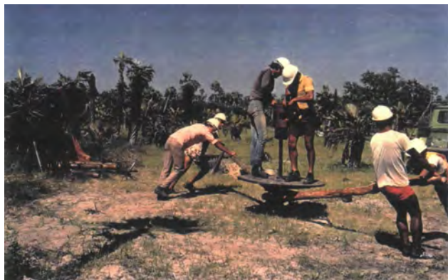
Figura 23 – Operação com sonda Banka para determinação da espessura da cobertura sobre os níveis de cascalho.
