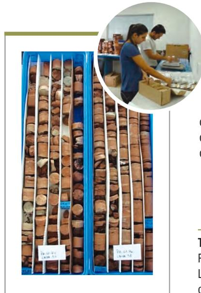
**FIGURA 12:** Catalogação de amostras na Litoteca Regional de Porto Velho e caixas padronizadas de testemunhos de sondagem.
