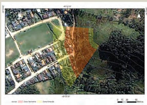
● Teste de aplicabilidade da metodologia preconizada pelo projeto GIDES em setor de risco delimitado no município de Apiaí (SP). De acordo com essa metodologia, em vermelho tem-se a área potencial de ruptura da encosta e, em amarelo, a área potencial de atingimento do material mobilizado.
