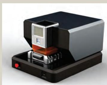
● Sistema de ablação a laser modelo New Wave Research-ESI 213 nm (NWR213).
