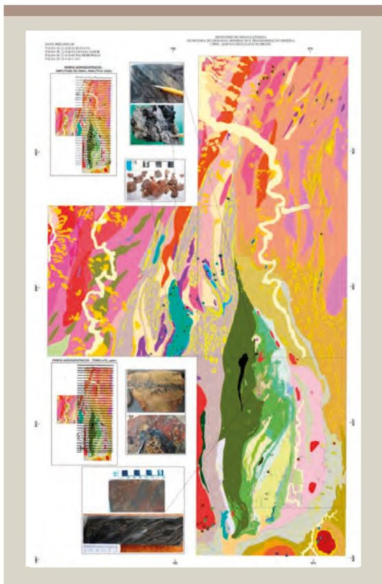
● Mapa geológico integrado preliminar. Circulado em preto (à esquerda), destaca-se o corpo de máfico-ultramáfica descoberto; à direita, o corpo de provável formação ferrífera bandada. Projeto Evolução Crustal e Metalogenia da Porção Central da Faixa Brasília.
