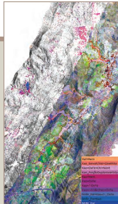
● Mapeamento espectral mineralógico em área de levantamento hiperespectral na serra das Pipocas (CE).
