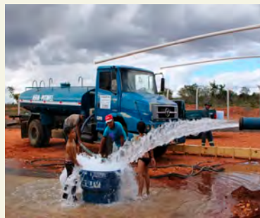
Teste de vazão em Tucano (BA).
