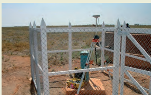
Levantamento com GPS geodésico – Projeto RIMAS (RN).
