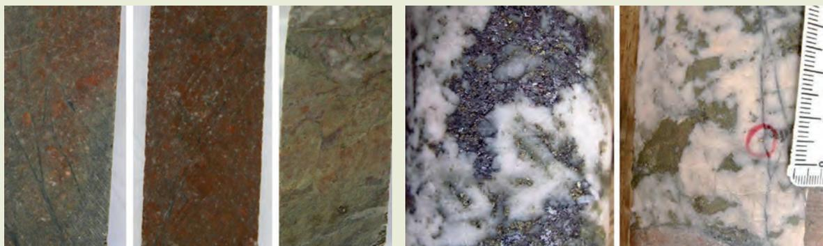
*Rochas vulcânicas com alteração hidrotermal potássica (à esquerda e no centro) e sericítica (à direita); veios de quartzo com galena e pirita (à esquerda) e pirita e ouro visível (círculo vermelho). Depósito Coringa, Área Tapajós Sudeste (PA).*
