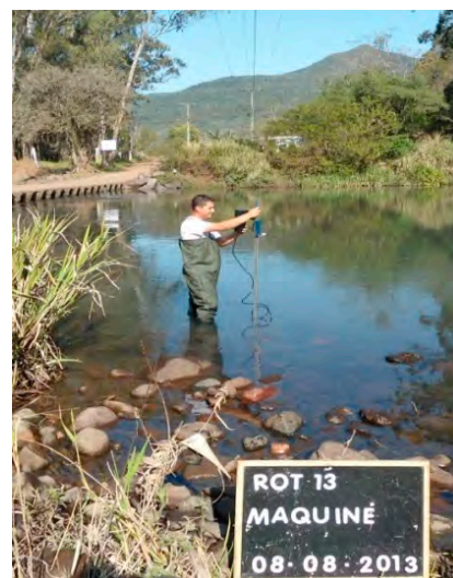
Operação com molinete no rio Maquiné (bacia da lagoa dos Patos, Maquiné, RS).
