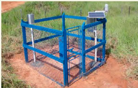
Plataforma de coleta de dados instalada junto ao poço de monitoramento.
