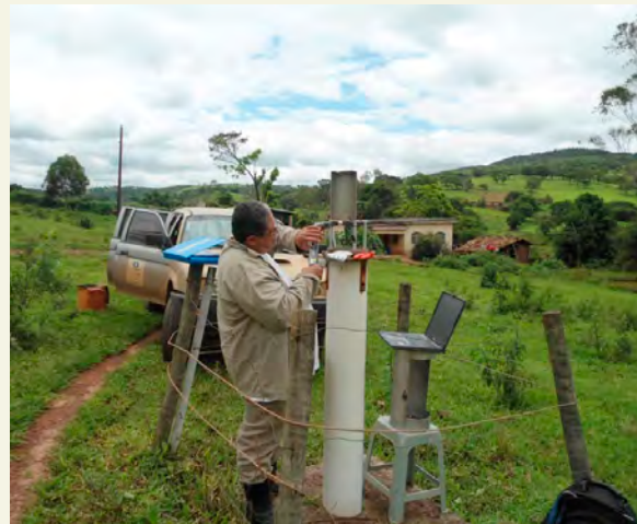
Estação de medição hidrológica na bacia do rio Catu (BA).
