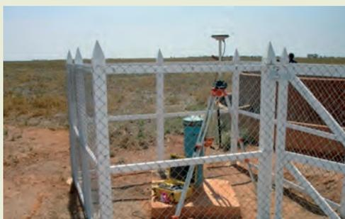
*Levantamento com GPS geodésico –
