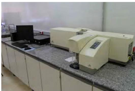
LSQA-MA/Sureg-MA: Equipamento para Determinação de Tamanho de Partículas de Sedimentos por Difração de Laser
