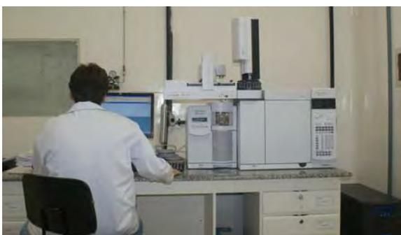
LAMIN-ERJ: Equipamento de Cromatografia Gasosa com interface com massas para análise de contaminantes orgânicos voláteis em água.
