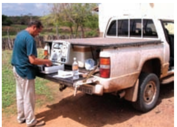
Análise de qualidade da água subterrânea realizada no campo, em unidade móvel.
