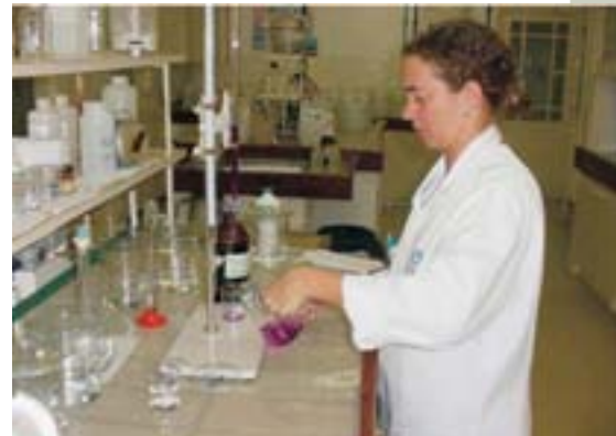
Técnica do LAMIM executando análise de carbonatos e bicarbonatos em água por volumetria.
