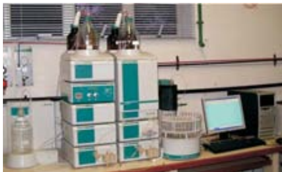
Cromatógrafos metroh2 , para determinação de ânions em água mineral.
