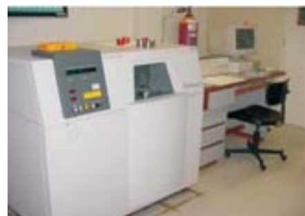
Equipamento de fluorescência de raios X para análise de minerais e rochas. Laboratório do LAMIN na CPRM/SGB, Escritório Rio de Janeiro.
