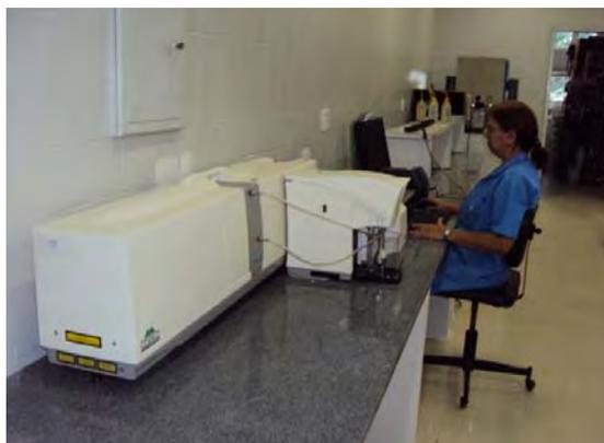
Granulômetro a laser Mastersizer 2000.
