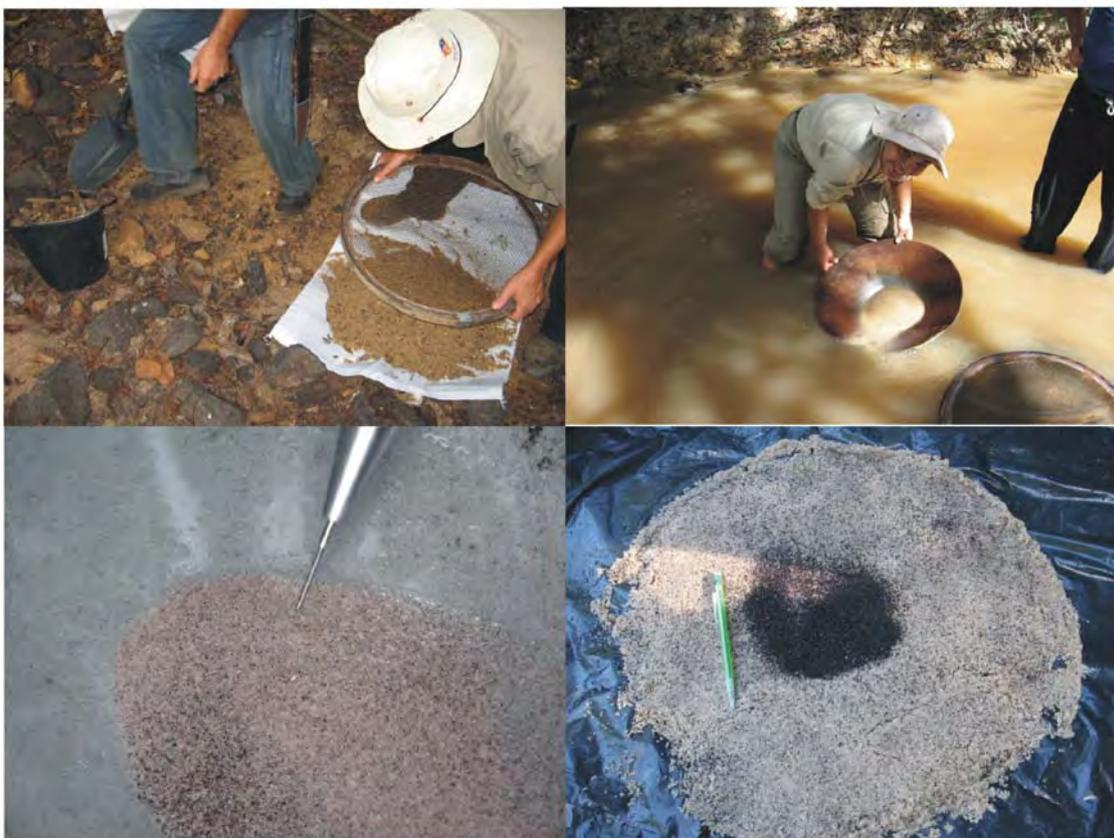
Prospecção geoquímica (sedimentos de corrente). Amostra com ouro (canto esquerdo inferior) e concentrado de minerais pesados (canto direito inferior).
