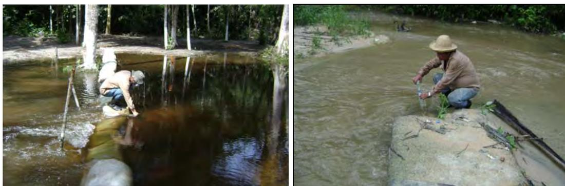
Igarapé Matrinxã: à esquerda, coleta de água a montante do aterro sanitário; à direita, coleta a jusante, com água já contaminada pelo chorume.
