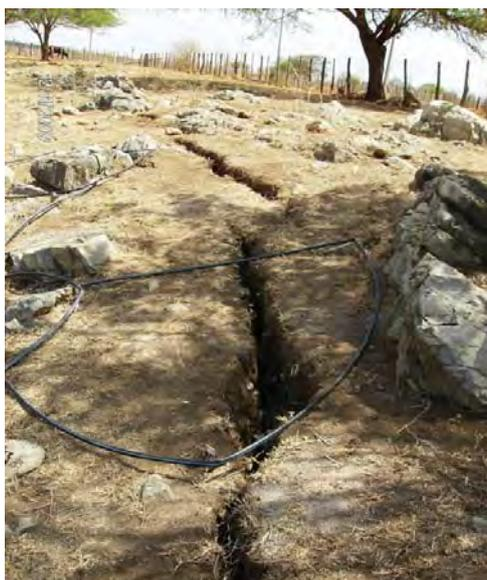
Rachaduras em solo, atribuídas à extração sem controle de água subterrânea (Lapão, BA).
