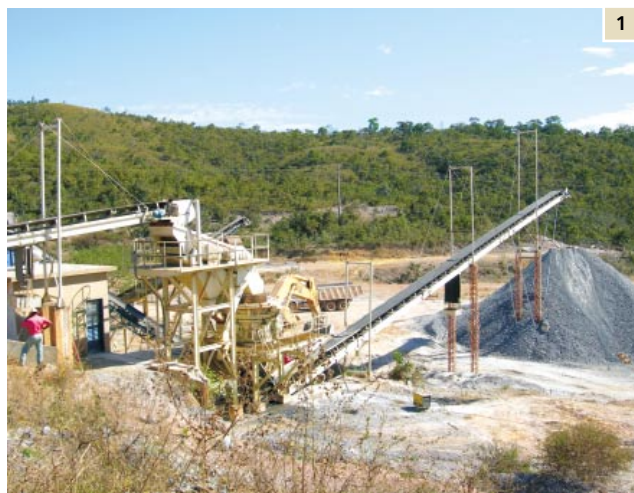
1 – Moageira de calcário para corretivo de solo. Mineração Calcário do Vale, Nova Xavantina, MT. Projeto Avaliação de Rochas Calcárias e Fosfatadas para Insumos Agrícolas do Estado de Mato Grosso.
