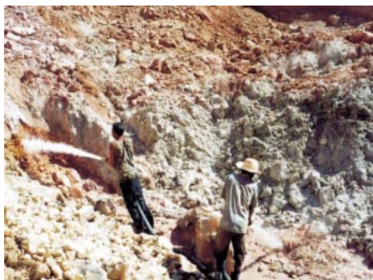
Exploração de quartzo por desmonte hidráulico do Garimpo de Pernambuco, município de Dueré, TO. Projeto Quartzo Industrial de Dueré-Cristalândia.
