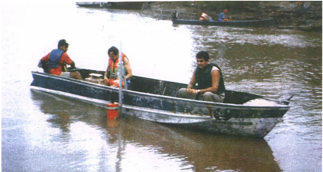
Equipe de operação da rede hidrometeorológica executando medição de descarga líquida, com perfilador de corrente por efeito Doppler (ADCP), Porto Velho, RO.
