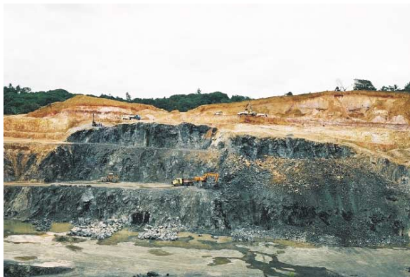
Morro de rocha granulítica com delgado capeamento de sedimentos cenozóicos, possibilitando a lavra para brita. Pedreira Parafuso (município de Simões Filho). Região Metropolitana de Salvador (BA).
