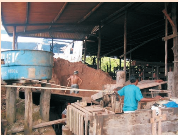
Fabricação de telhas e tijolos a partir de argila (Setor Oleiro de Iranduba-Manacapuru, AM). Projeto Materiais de Construção na Região Metropolitana de Manaus(AM).
