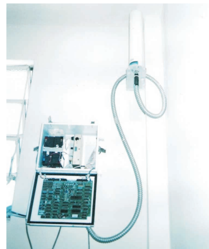
Plataforma de Coleta de Dados (PCD) instalada na Estação Fluviométrica de Uruguaiana (RS).
