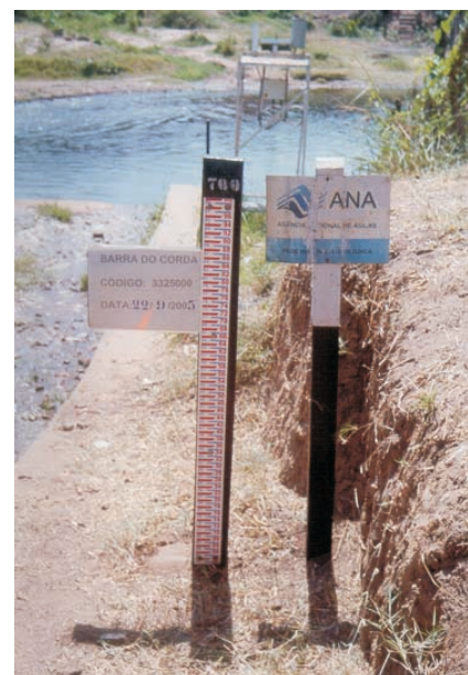
Règua Fluviométrica e Plataforma de Coleta de Dados (PCD), instalada na Estação Fluviométrica de Barra do Corda (MA).
