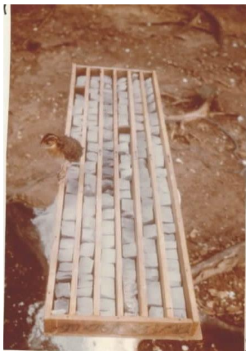
Figura 9 – Forma de acondicionamento de testemunhos de sondagem, no caso um testemunho fragmentado relativo ao furo AV-45-PA.
