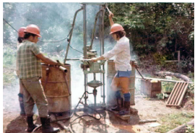
Figura 11 - Operação com sonda rotativa Winkie GW15.
