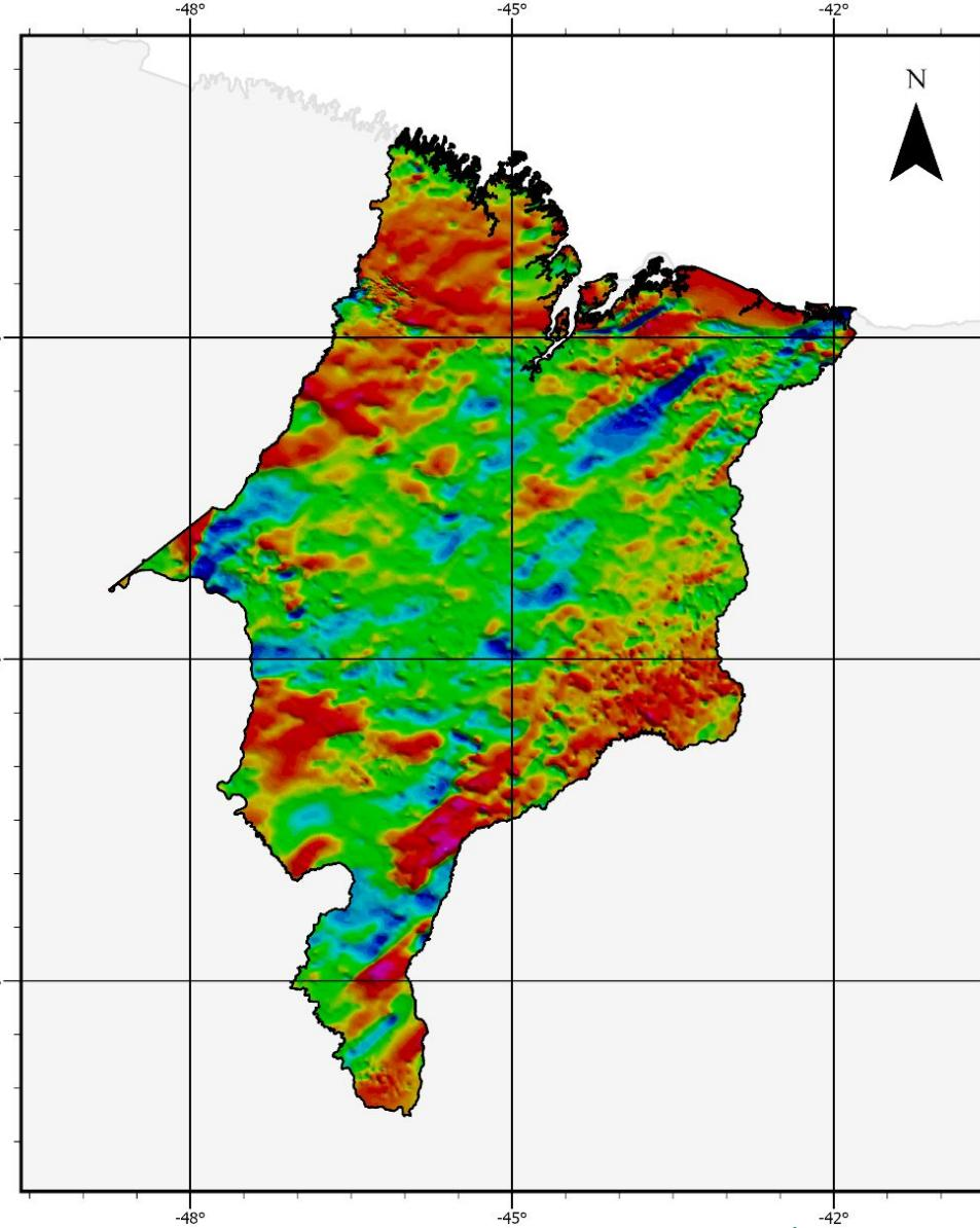
Os levantamentos magnetométricos e gamaespectrométricos de 256 canais auxiliam no cartografia geológica e na identificação de diferentes tipos de mineralizações, através de diversos subprodutos oriundos do pós-processamento dos dados realizado pelos Pesquisadores do SGB.
