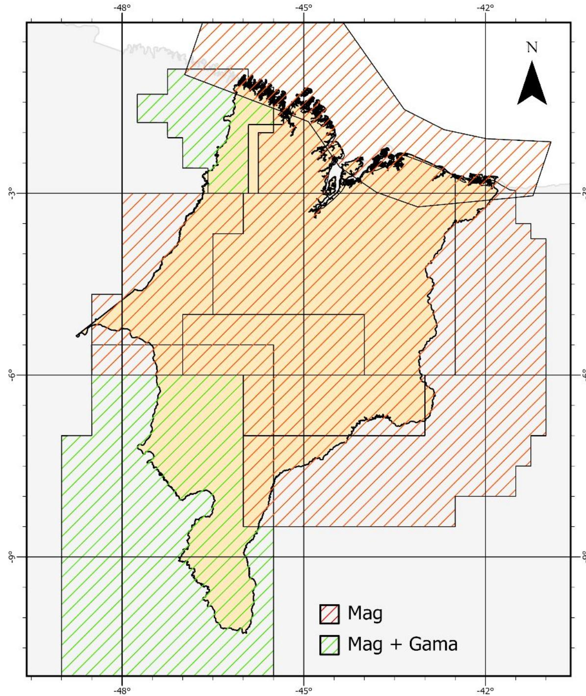
Os levantamentos existentes no Estado do Maranhão foram adquiridos pelo convênio CNP e Petrobrás. São levantamentos com diversas resoluções espaciais (500 – 3000 m) e alturas de voo (100 – 800 m).
