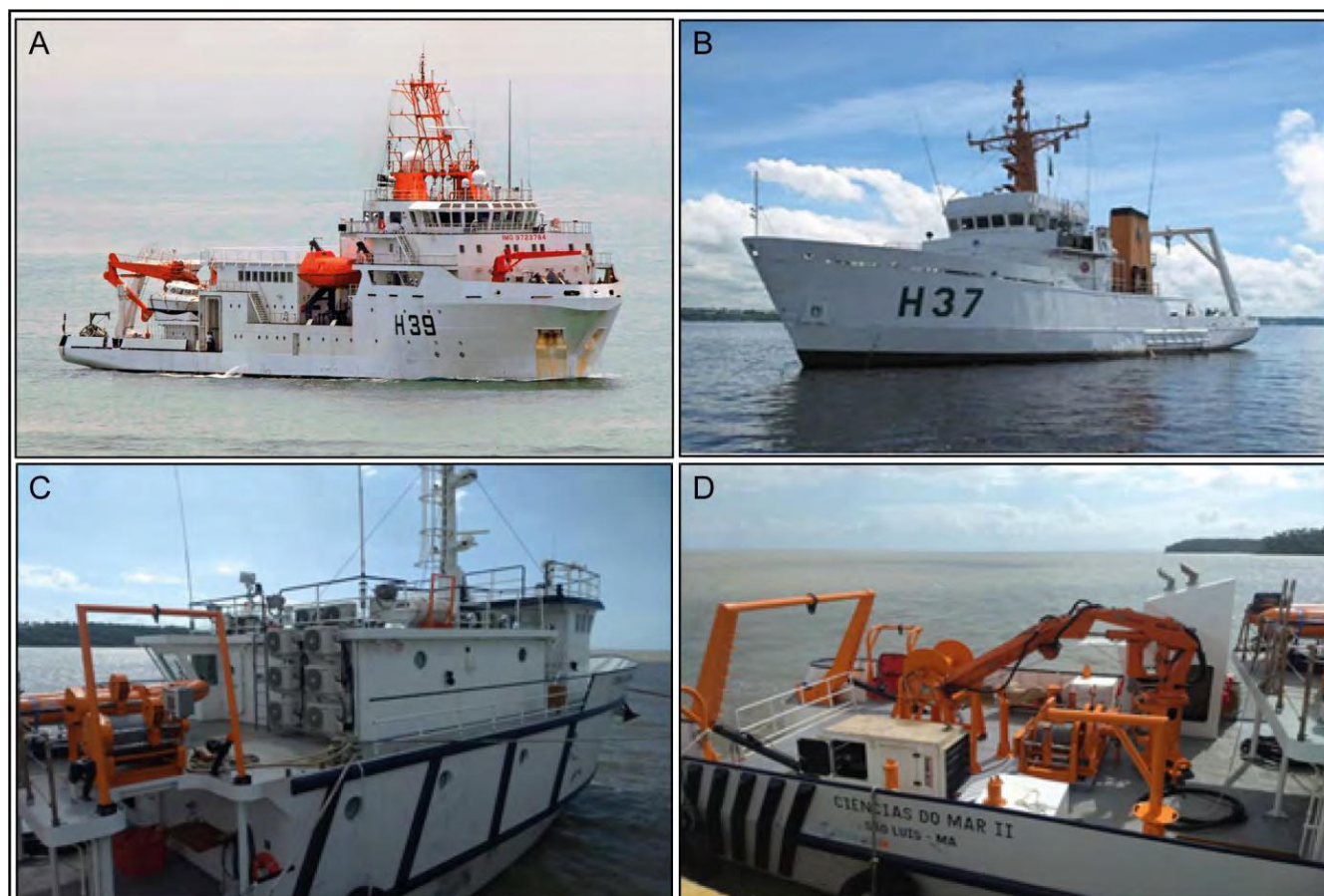
Figura 15: (A) Navio de pesquisa hidroceanográfico Vital de Oliveira com 78 metros de comprimento destinado aos levantamentos ambientais e mergulho com ROV, (B) navio hidroceanográfico Garnier Sampaio com 47,60 metro de comprimento a ser utilizado para o levantamento batimétrico com multifeixe MBES, sonográfico e sísmico e (C e D) o navio Ciências do Mar II (UFMA) com 32m de comprimento a ser utilizado para o levantamento batimétrico com multifeixe MBES, sonográfico e sísmico, oceanográfico, geológico e ambiental.
