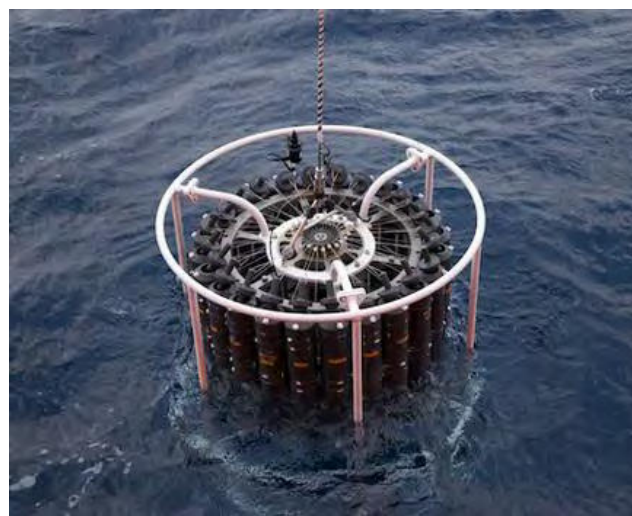
Figura 02: Roseta para coleta de água para as seguintes análises: 1) Oxigênio Dissolvido (OD); 2) Alcalinidade e Carbono Inorgânico Dissolvido; 3) pH; 4) Potencial Redox (Eh); 5) Salinidade; 6) Carbono e Nitrogênio Orgânico Total (CHNS); 7) Carbono Orgânico Particulado (COP) e Nitrogênio Orgânico Particulado (NOP) Nutrientes (5 macronutrientes); 8) Material Particulado em Suspensão; 9) Comunidade Microbiana; 10) Atividade Metabólica Microbiana; 11) Clorofila-a e 12) Comunidade Fitoplanctônica.
