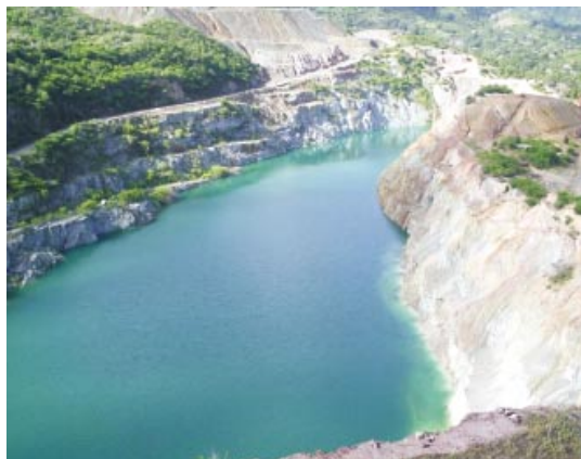
Vista da frente de lavra, em parte coberta por águas ácidas oriundas da lixiviação dos minerais sulfetados e de pilhas de rejeito ao fundo (Mina "El Cobre", Santiago de Cuba).
