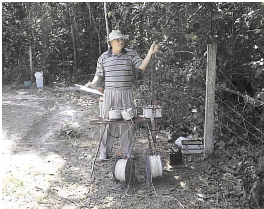
Levantamento geofísico nas imediações do poço de monitoramento PT-3 contaminado por chorume, no vale do igarapé Aracu, para delimitação da pluma poluidora proveniente do aterro sanitário de Manaus (AM).
