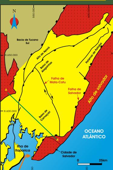
Mapa Geológico esquemático da Bacia do Recôncavo, indicando as principais falhas que delimitam e compartimentam a bacia sedimentar.
