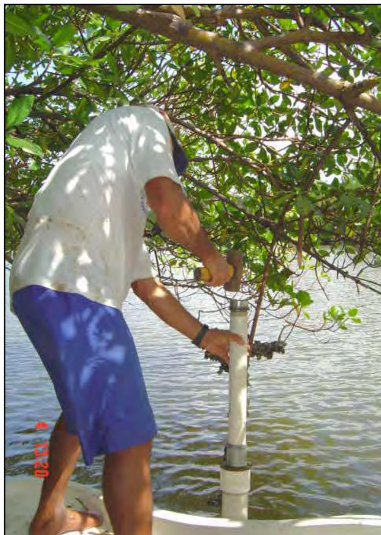
Figura 20 - Amostragem à percussão de perfil sedimentar
