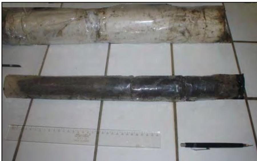
Figura 15 - Perfil sedimentar, em invólucros de plástico
