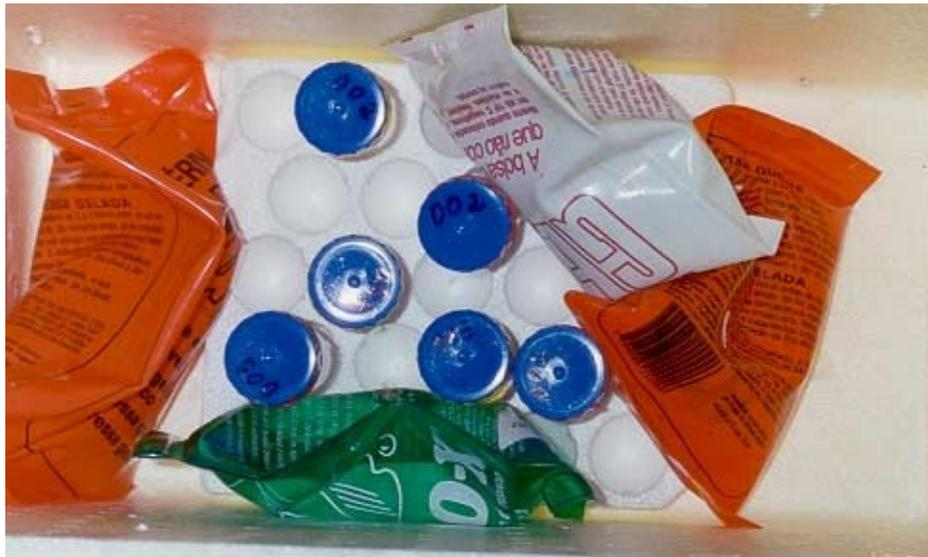
Foto 8: Amostras acondicionadas na bandeja dentro da caixa de isopor com as bolsas térmicas
