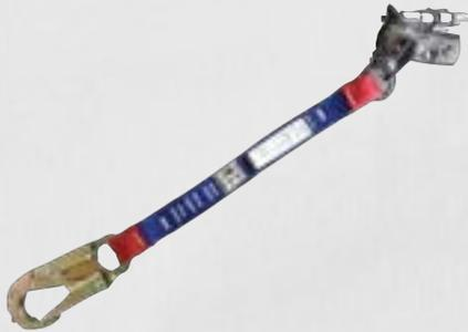
Trava-queda para corda de 12 mm, fechamento dupla trava, conector com abertura de 25 mm, conector classe T trava dupla, extensor medindo 30 cm de comprimento, largura do extensor de 25 mm, alavanca para posicionar equipamento na corda.
