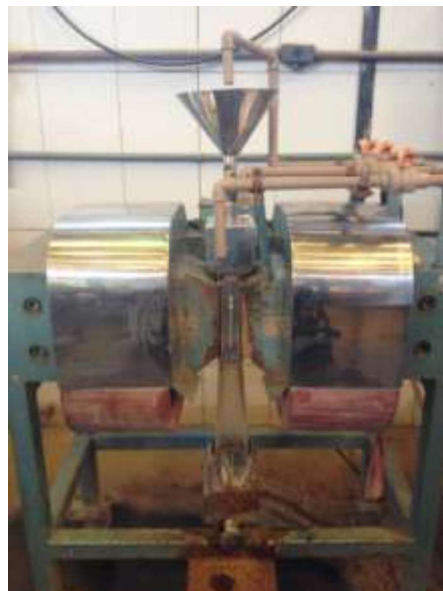
Figura 5. Separador magnético Boxmag Rapid (14.000 Gauss).
