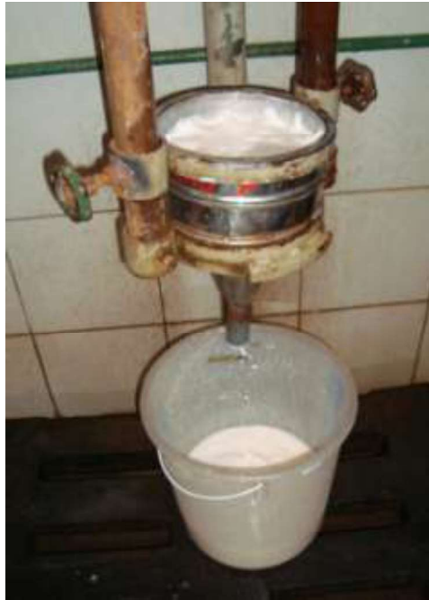
Figura 4. Classificação granulométrica a úmido.
