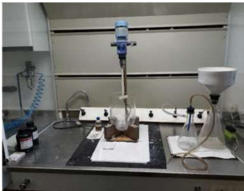
Figura 6. Alvejamento químico com ditonito de sódio.
