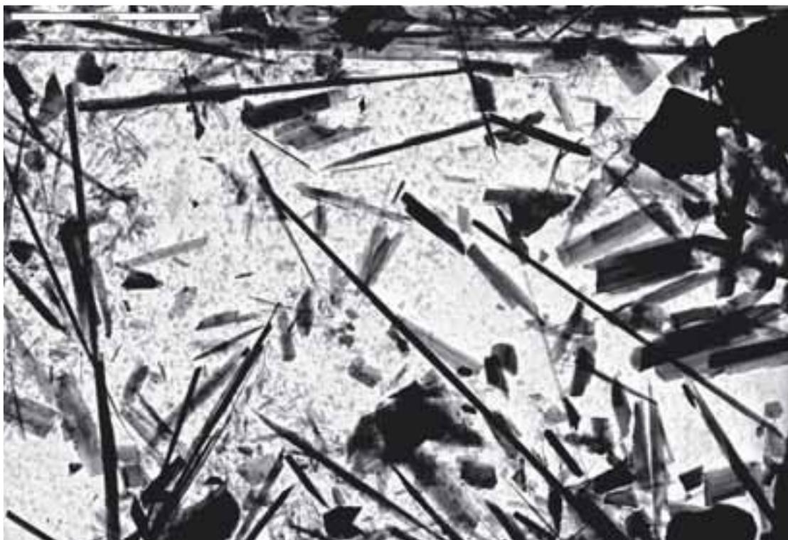
◀ **Photo 4 : Fibres d'amiante amphibole trémolite au microscope électronique à transmission (X 1500) dans un échantillon de roche provenant de l'affleurement de Lanslebourg (Savoie).**
