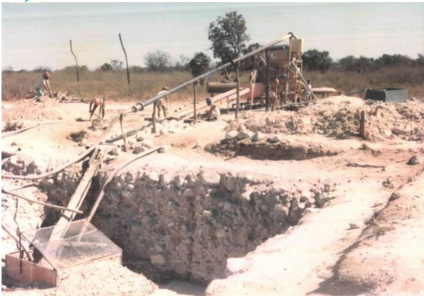
Amostra a granel C-8 – Setor Pega, no nível superior do cascalho. Material < 1/4'' sendo removido pela bomba de sucção para o Ourotec M-10.
