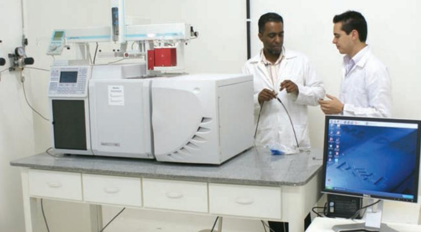
Instalação do cromatógrafo gasoso com interface para massa (GC-MS-MS).
