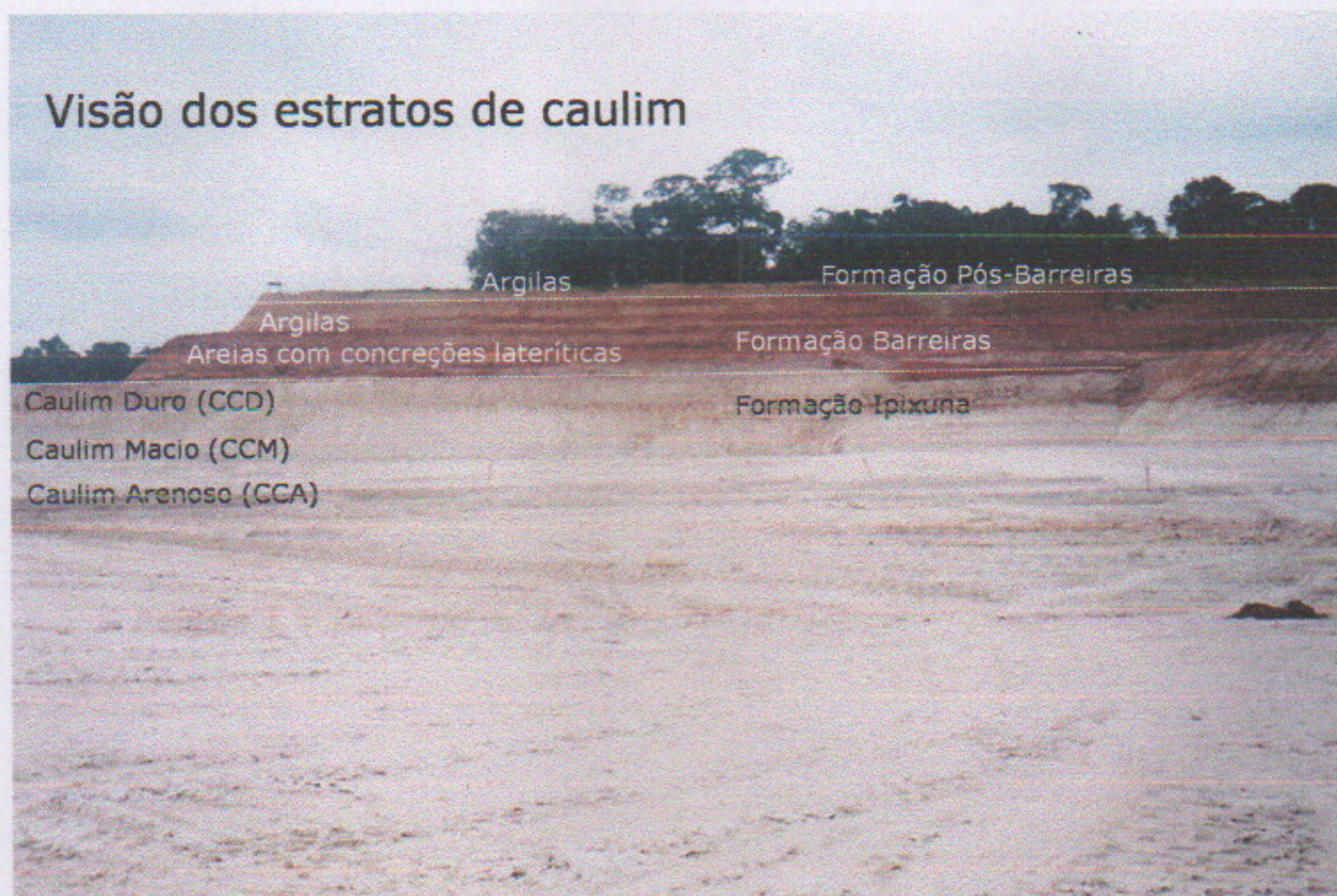
Figura 10: Visão geral das camadas de caulim e as suas correlações verticais e horizontais.
