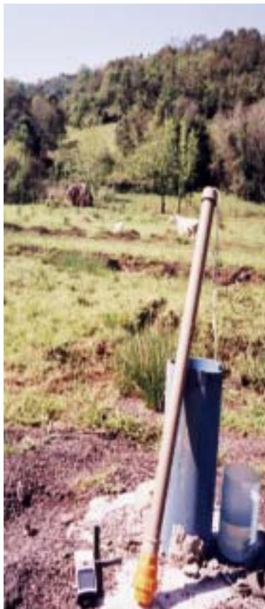
**Figura 44** - Amostrador de água utilizado em poços desprovidos de equipamento de bombeamento. Poço localizado na Barra do Traíra-Guaraciaba.
